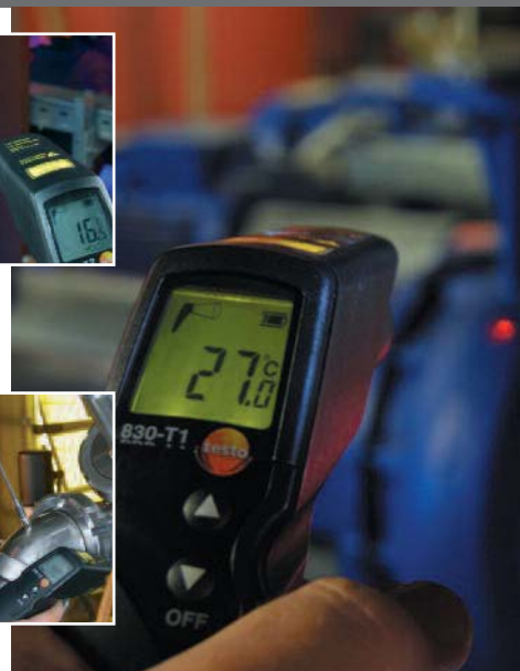
Temperatur-Schnelltest an technischen Anlagen
